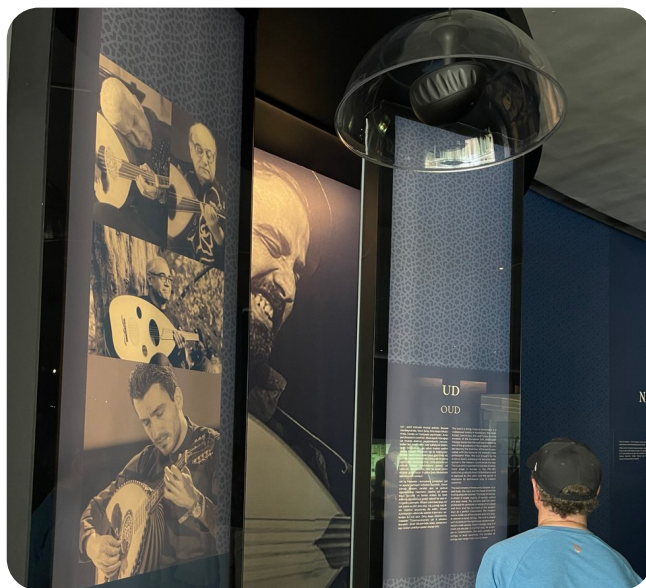
Реализация технологии направленного звука (звукового душа) в Центре Гейдара Алиева в Баку
